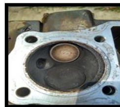
Gambar 2. Kondisi ruang bakar sebelum memakai aditif
