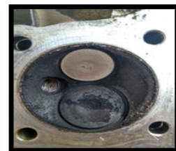
Gambar 3. Kondisi ruang bakar setelah memakai aditif
